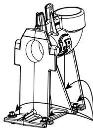
2. À l'aide des boulons fournis, monter la griffe sur le refoulement de la pompe.
